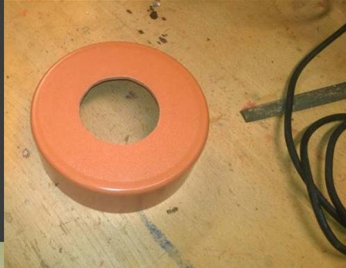
5.01. Rohrabdeckung für LED – Lampe mit Lochkreissäge aussägen
